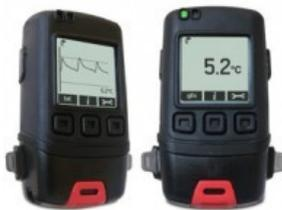
O registador e dados apresenta três botões que permite aos utilizadores iniciar, parar e reiniciar o registador de dados usando os menus no visor. Também fornece uma análise em tempo real de dados como um resumo de dados mostrando as leituras máximas, mínimas e as condições de alarme.
